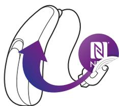
**1** Der NFC-Chip wird an ein Produkt angebracht.
